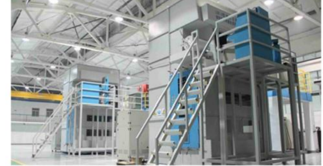
C919飞机钛合金结构件成形专用装备
